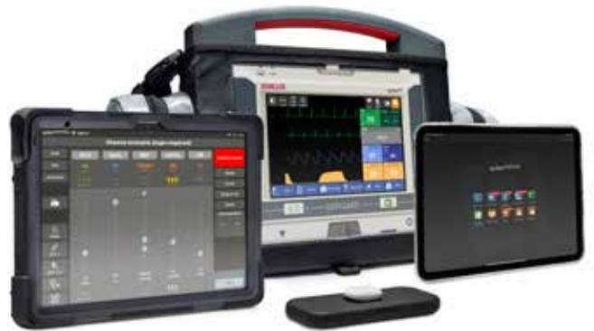
Ein einsatzbereites Simulationssystem besteht aus einem **Hardware SET** und der **Simulationssoftware** des jeweiligen Geräteherstellers.
